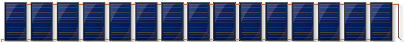
Die wechselseitige Verschaltung von bis zu 15 Kollektoren in einer Reihe ist mit jeder Bauform - vertikal oder horizontal - sowie mit beliebiger Kollektordimension - FKF 200, FKF 240 oder FKF 270 - möglich.
