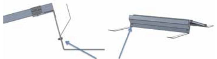
Fixierung der Erdungsklemme am Verbinder mit der M8 Schraube am Ende von jedem String
