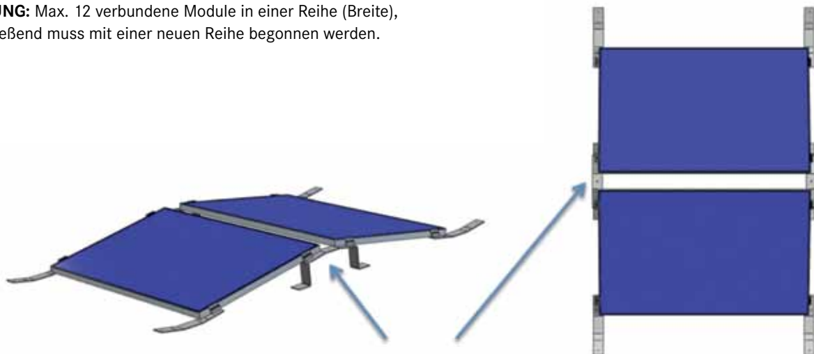
Fixierung der Erdungsklemme am Verbinderelement mit der M8 Schraube am Ende von jedem String
